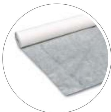
Feltro transpirable y difusor de vapor formado por dos capas de fieltro de polipropileno que recubren un film interior de polietileno. Para aplicación como capa de ventilación y difusión del vapor en aplicaciones "bajo teja".
