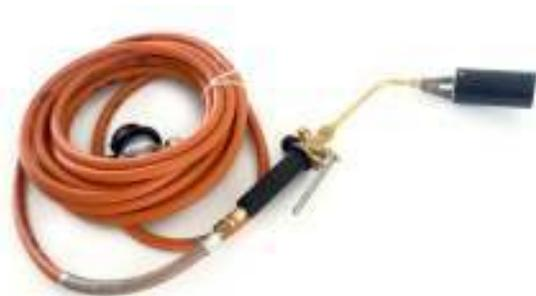
Herramienta de combustión para soldar láminas bituminosas, a gas propano.
